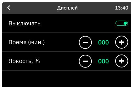
При касании отключённого дисплея происходит его включение: устанавливается яркость 100% и активируются кнопки перехода на другие экраны.
