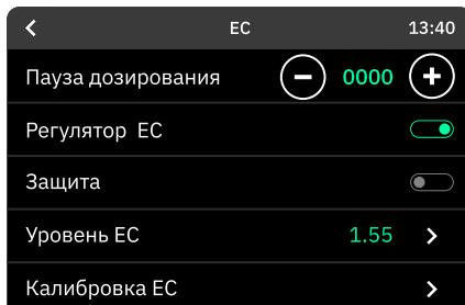
Пауза дозирования удобрений определяется временем протекания переходных процессов в растворе после подачи удобрений. Методика оценки паузы дозирования удобрений аналогична методике оценки паузы дозирования для регулятора pH (см. «**Экран параметров регулятора pH – стр. 36**»).
