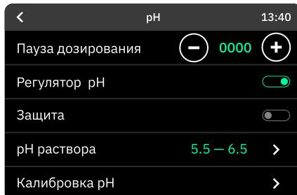
Пауза дозирования должна быть выбрана таким образом, чтобы между двумя дозировками регуляторов кислотности в растворном баке прошли переходные процессы (перемешивание раствора, химические реакции регулятора кислотности с компонентами раствора, переходные процессы в pH-электроде).
