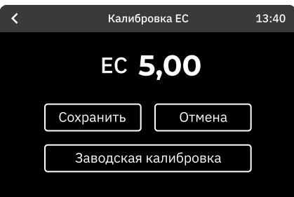
Калибровка датчика ЕС (см. «**Главный экран – стр. 28**») производится по двум точкам. На экранах калибровки есть счётчики для ввода значений ЕС калибровочных растворов.
