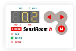
Время полива — это время, в течение которого прибор подает питание на насос (помпу или электромагнитный клапан).
