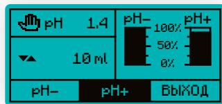
В левой верхней части окна отображается текущее значение pH, в средней части отображается выбранный объём дозировки. Внизу в строке меню можно выбрать необходимый реагент. Справа на двух шкалах графически показан выбранный объём дозировки для каждого реагента.
