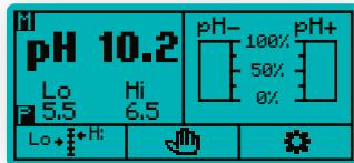
Прибор переключается в режим ручного регулирования, буква **A** на главном экране сменится на **M** (Manual).
