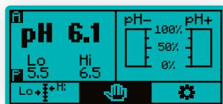
Режим «Ручное управление» предназначен для ручной дозировки реагентов. Данный режим позволяет выбрать дозировку от 1 до 10 мл. Выделите стрелкой ► в строке меню главного окна, среднее окошко. Нажмите кнопку «OK», откроется окно ручного управления.
