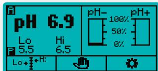
Буква в левом верхнем углу экрана указывает в каком режиме находится прибор. А (Auto) – автоматическое регулирование, М (Manual) – ручное управление. Буква Р в нижнем левом углу экрана – защита включена.
