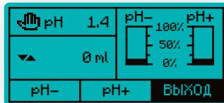
Выбрав режим «**ручная**» прибор будет дозировать выбранный компонент при нажатии и удерживании кнопки «**OK**». Для выхода из этого режима перейдите на вкладку «**Выход**» в строке меню и нажмите «**OK**».
