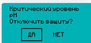
При выборе ответа «ДА» регулятор продолжит работу в автоматическом режиме, защита будет **выключена**. Прибор будет продолжать работу в автоматическом режиме. Буква «Р» на главном экране погаснет (защита выключена).
