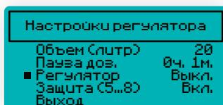
Для продолжения работы в режиме автоматического регулирования перейдите в меню: **Настройки / Настройки регулятора / Регулятор ВЫКЛ.**. Для включения необходимо в строке **Регулятор ВЫКЛ.**, кнопкой выбрать **ВКЛ.**
