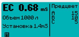
Буква в левом нижнем углу экрана указывает в каком режиме находится прибор. **A** (Auto) – автоматический режим, **M** (Manual) – ручной режим.
