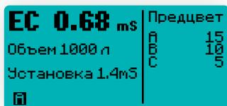
В левой верхней части экрана отображается текущее значение ЕС, ниже отображен объём гидропонной системы в литрах, ещё ниже уровень ЕС раствора, который в данный момент поддерживает прибор.
