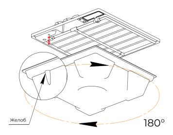
Установите уплотнитель и отводной фитинг снизу крышки. Установите минимальный уровень для дренажной трубки. В этом случае излишки раствора будут сливаться обратно в бак. Отводной фитинг выступает в качестве запасного слива.
