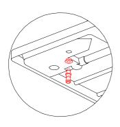
**3** Снизу крышки установите уплотнитель и І фитинг
